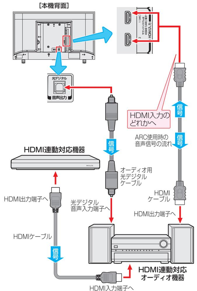
※ ARC対応のオーディオ機器を、ARC対応のHDMIケーブルでHDMI入力1 (ARC)端子に接続する場合は、光デジタルケーブルの接続は不要です。
